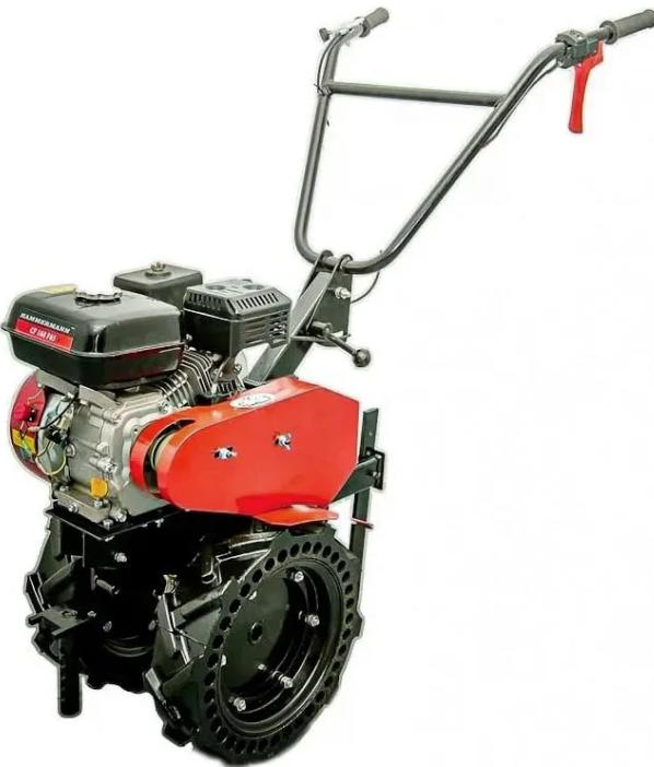
Бензиновый мотоблок Тарпан ТМЗ-МБ-07-01 оснащен 4-тактным бензиновым двигателем мощностью 6,5 л.с. Аппарат может работать как с фрезами, идущими в комплекте, так и с дополнительным навесным оборудованием. Ширина вспашки составляет 70 см, а глубину погружения фрез можно регулировать при помощи сошника до 20 см.
