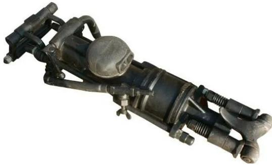
Перфоратор пневматический ПП-60 НВ, предназначен для бурения горизонтальных, вертикальных и наклонных шпуров глубиной до 5м, в горных породах и других материалах. Используется в горнодобывающей промышленности и строительстве.
