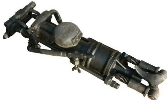
Пневматический перфоратор повышенной мощности ПП-80 НВ предназначен для бурения горизонтальных и наклонных шпуров диаметром до 46 мм и глубиной до 9 метров в горных породах и других материалах крепостью до 20 единиц по шкале проф. М.М. Протодьяконова.
